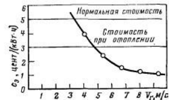
Рис. 5.16. Влияние среднегодовой скорости ветра V_T на стоимость энергии c_0 , производимой ВЭУ.
