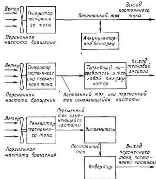
Рис. 5.1. Схемы использования электрической энергии, производимой ВЭУ, при ее изолированной работе.
