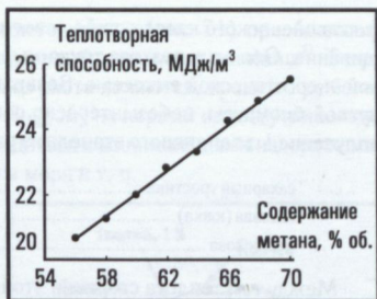
Рис. 70. Зависимость теплотворной способности биогаза от содержания в нем метана. Исходные данные 15)
