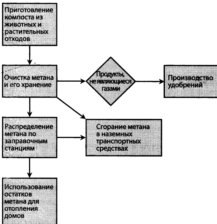
Рис. 13.3. Производство метана на компостных заводах из растительного сырья и животных отходов
