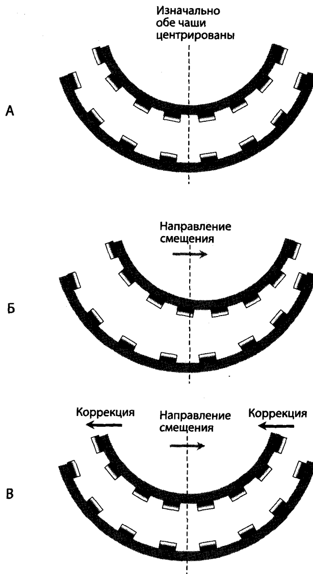
Рис. 9.2. Компенсационная система (система обратной связи) поддерживает устойчивую центровку двух чаш с магнитами, обеспечивая эффект магнитной левитации. На рисунке А чаши центрированы. На рисунке Б нестабильность системы вызывает смещение верхней чаши. На рисунке В корректирующий импульс компенсационной системы возвращает верхнюю чашу на одну ось с нижней
