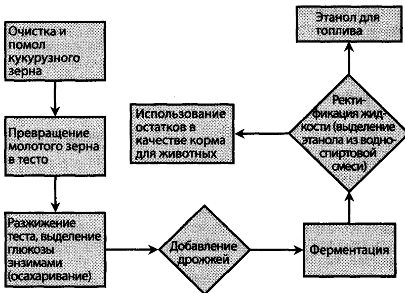
Рис. 7.2. Использование технологии сухого помола для выделения этанола из кукурузных зерен, а также получения побочного продукта, идущего на корм животным
