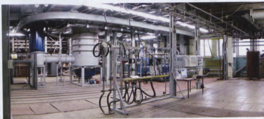
Рис. 5. Установка плазменной газификации отходов (Россия, ИЭЭ РАН)
